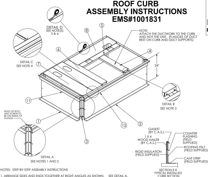
. ARRANGE SIDES AND ENDS TOGETHER AT RIGHT ANGLES AS SHOWN. SEE DETAIL A. CÜRB SECTION
